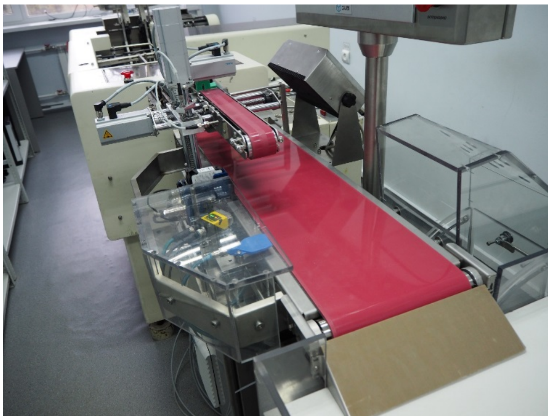
Рис. 10 Аппарат для комплектации лекарственных препаратов во вторичную упаковку
